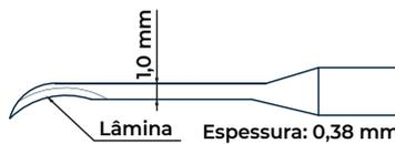
**Lâmina Curva:** Esta lâmina possui uma geometria de corte em arco facilitando fisgar tecidos para corte e geralmente é utilizada em cirurgias transesfenoidais e em incisões de tecidos moles.
