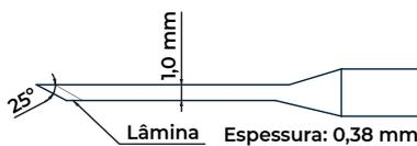
**Lâmina Reta:** Esta Lâmina possui uma afiação na extremidade em ângulo (25°), sua geometria pontiaguda facilita a punção e incisões em locais estreitos.
