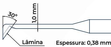
**Lâmina Gancho:** Esta lâmina possui uma geometria de corte com o formato de gancho em L facilitando pequenas perfurações e cortes precisos e geralmente é utilizada em cirurgias para remoção de tumor cerebral, separação de tecidos moles e descompressão microvascular.
