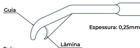
**Lâmina Dura-Máter:** Estas Lâminas foram projetadas especialmente para corte da dura-máter, sua proteção curvada e sem corte protege os tecidos subjacentes enquanto sua lâmina ultra afiada promove um corte seguro e minimiza os riscos de lesões.
